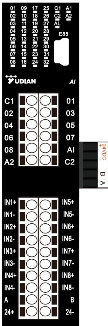
D92 尺寸本身无显示器及键盘，可通过 RS485 通讯接口与上位机计算机或触摸屏连接来完成其显示界面的功能及操作，也可以利用外接的 E85 型键盘及显示器进行显示及参数设置。
